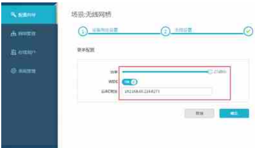
图 3-29 无线网桥配置
