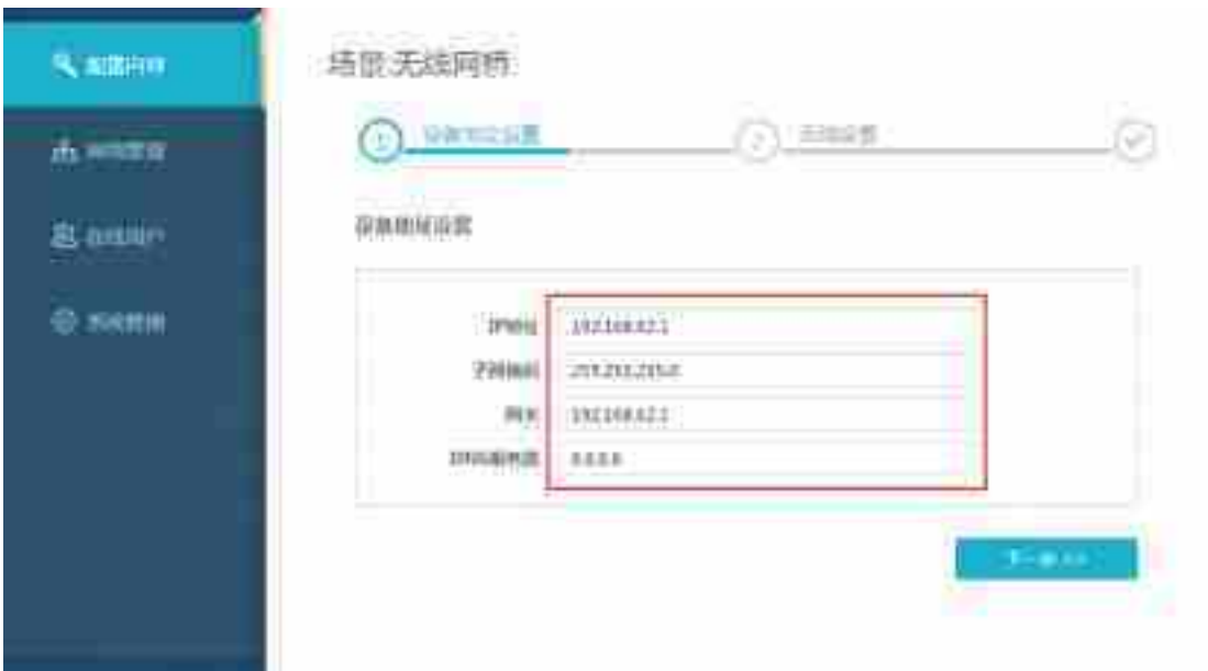
图 3-26 无线网桥配置
