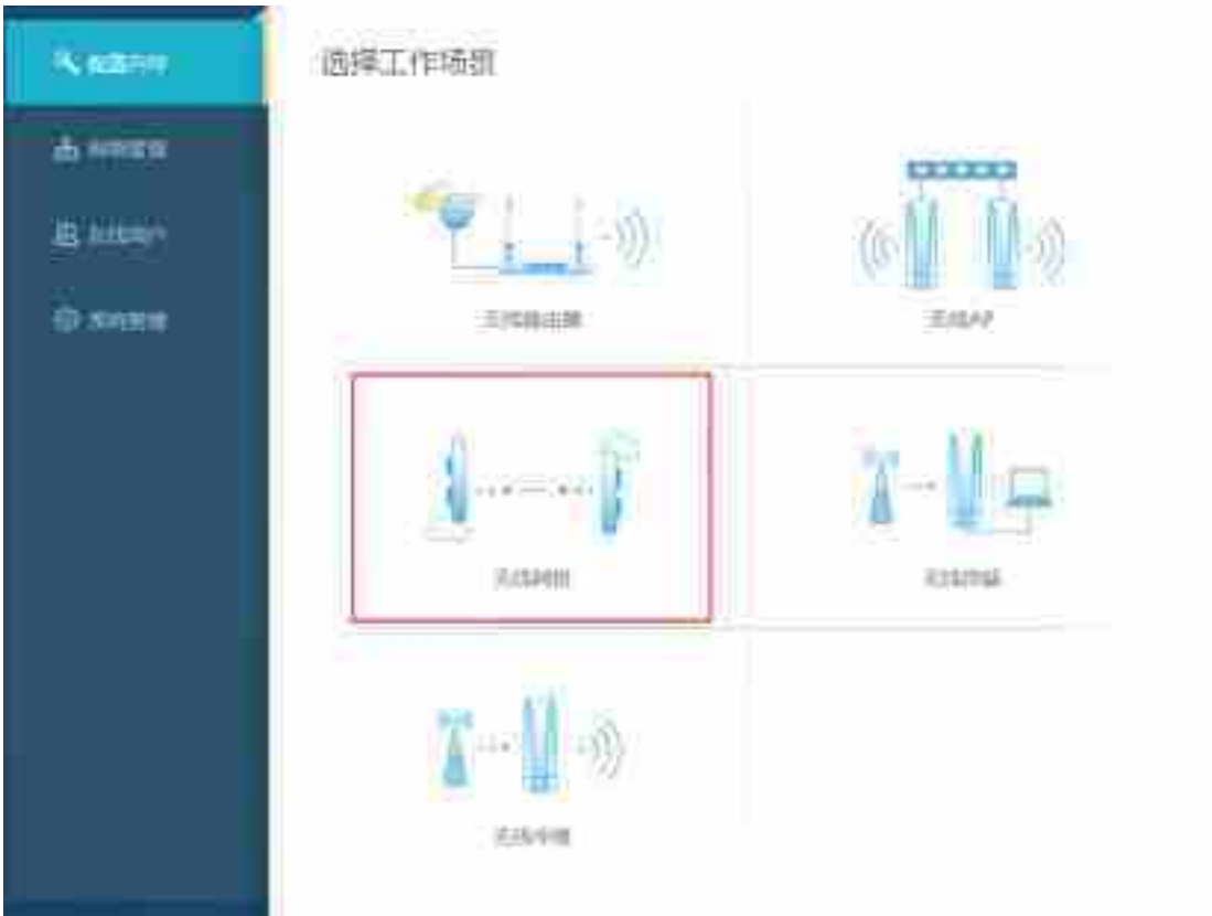
图 3-25 无线网桥配置
