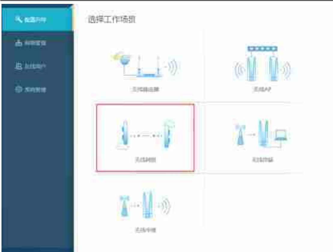
图 3-19 无线网桥配置
