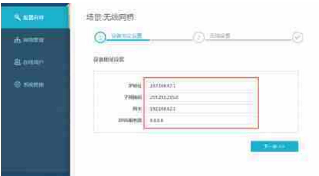
图 3-20 无线网桥配置
